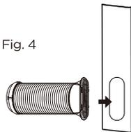
**REMARQUE:** Le tuyau d'échappement peut être comprimé ou étendu modérément, mais il est souhaitable de garder la longueur au minimum. Assurez-vous également que le tuyau n'a pas de coudes serrés.
