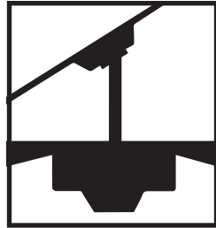
Instalación en techo abovedado
